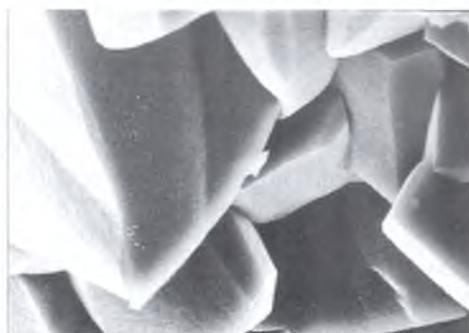
Рис. 13.12. Рельефные зерна целестина (электронная микрофотография [303])
