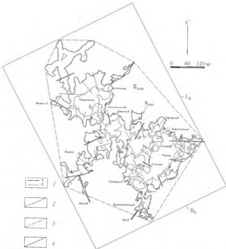
Рис. 9.10. Схема определения морфометрических параметров Кунгурской пещеры. 1 — направления сечений пещеры, выполненных по замерам стационара в 1949 (а) и 2002 (б) гг.; 2 — параметры призма Корбеля; 3 — контур выпуклого многоугольника, вмещающего пещеру ( $S_{обл}$ ); 4 — контур выпуклого многоугольника, описывающего пещеру ( $S_{опис}$ ).
