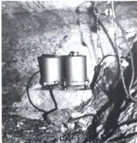
Рис. 15.9. Наклономерная станция "Кунгур" (фото В. И. Солухи)
