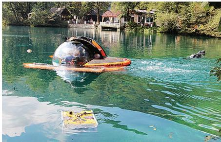
Рис. 4. Аппараты C-Explorer-3 и Марлин-350 в процессе работы
