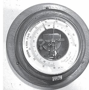
Рис. 5. Барометр-анероид
