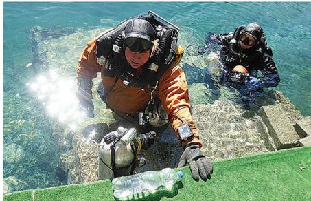
Рис. 2. Отбор проб воды с глубины водолазом
