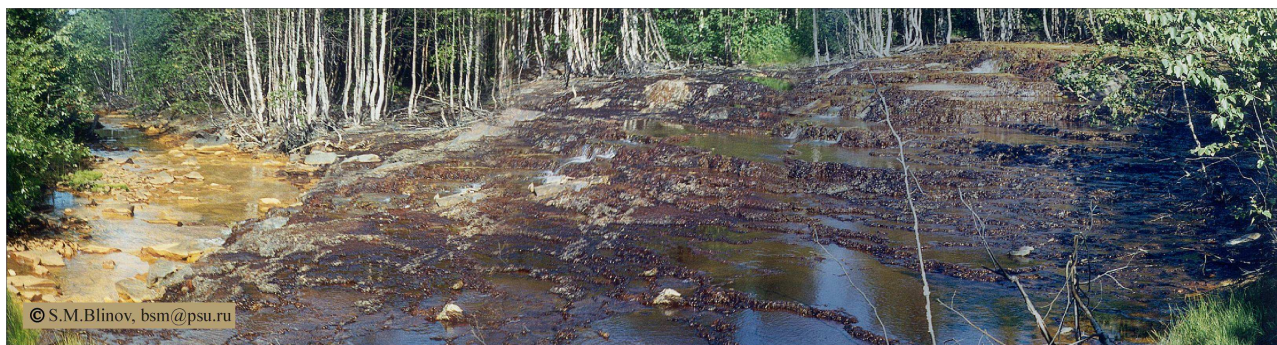
Рис. 6. Отложения гидроксидов железа из шахтных вод, изливающихся из шах. «Белый Спой»
