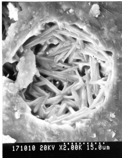
Рис. 9. Кристаллы муллита в пустотах спекшихся силикатных пород из горелого отвала.
