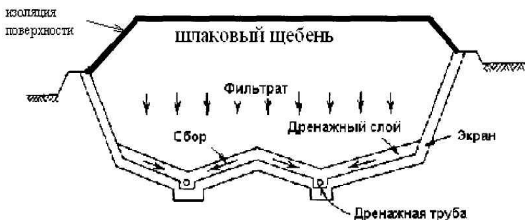
Рис. 2. Система обустройства площадки хранения шлаков
