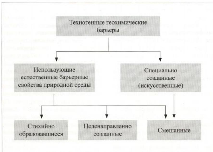
Рис. 1. Разновидности техногенных геохимических барьеров, используемых для охраны окружающей среды
