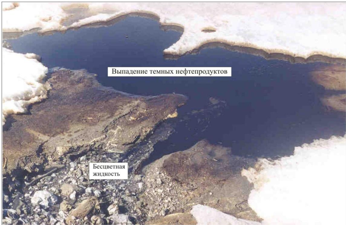
Рис. 2 Выпадение темных нефтепродуктов при разгрузке загрязненных подземных вод в Камское водохранилище
