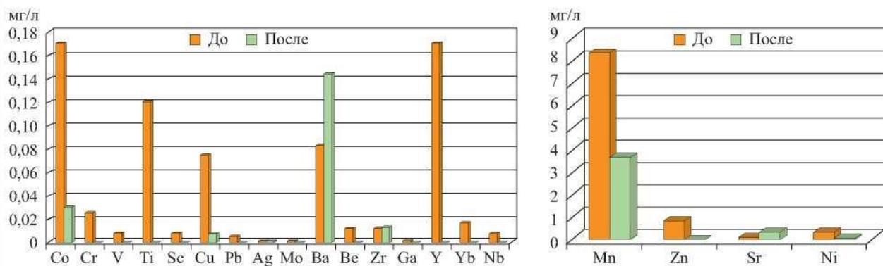
Рис. 9. Микроэлементный состав воды самоизлива шахты «им. 40 лет Октября» до и после опытно-промышленной очистки отходами БСЗ
