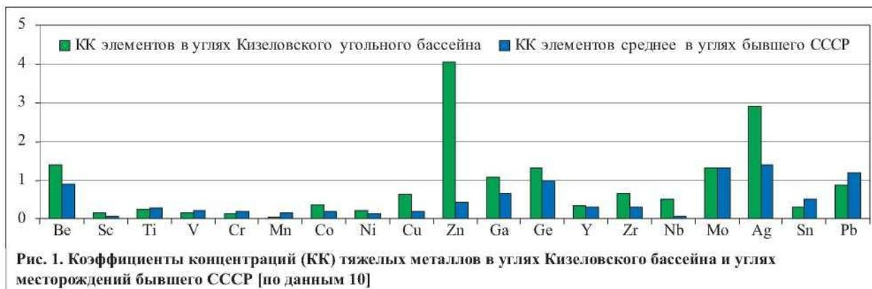
Рис. 1. Коэффициенты концентраций (КК) тяжелых металлов в углях Кизеловского бассейна и углях месторождений бывшего СССР [по данным 10]
