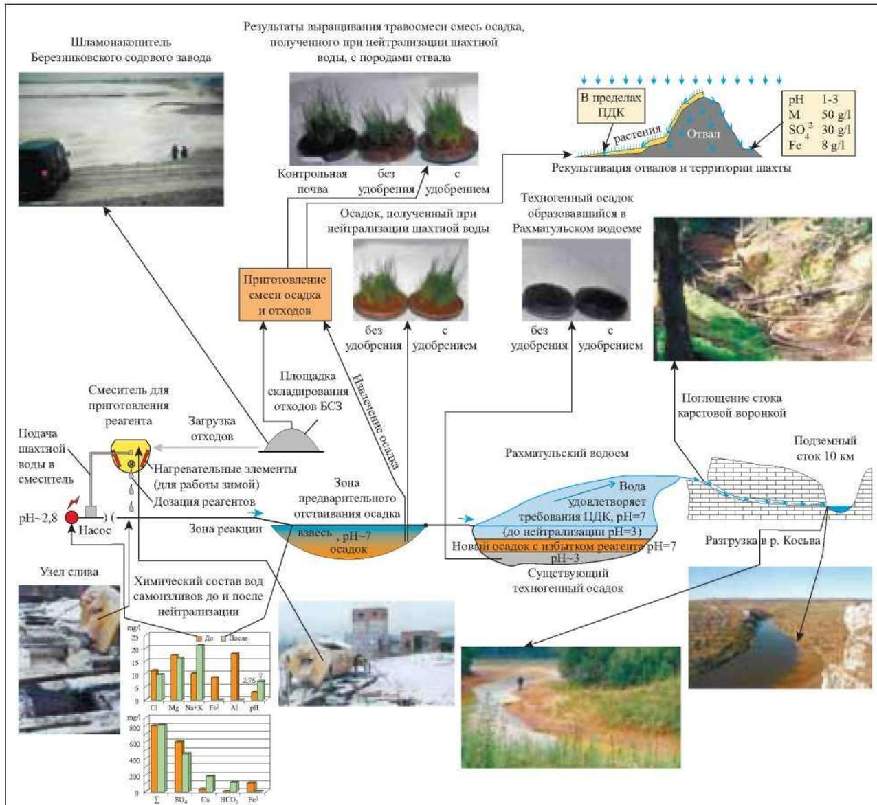
Рис. 7. Общая технологическая схема улучшения экологической обстановки на территории Кизеловского угольного бассейна с использованием отходов БСЗ на примере шахты «им. 40 лет Октября»
