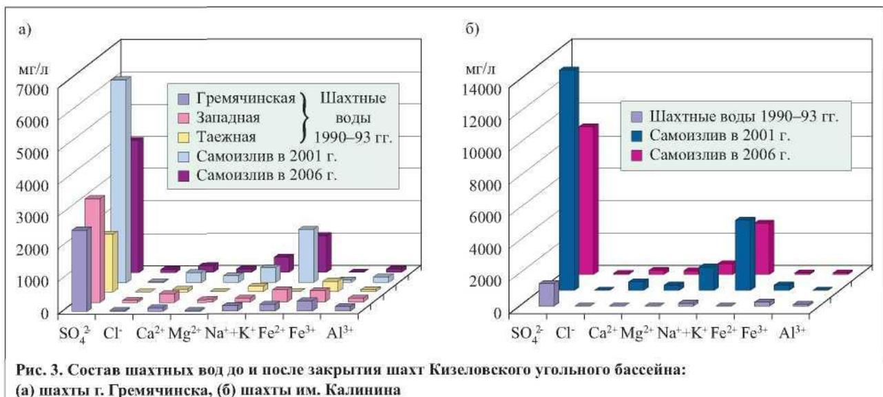
Рис. 3. Состав шахтных вод до и после закрытия шахт Кизеловского угольного бассейна: (а) шахты г. Гремячинска, (б) шахты им. Калинина
