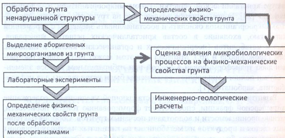
**Рис 1. Исследования влияния микробиологических процессов на свойства грунтов**
