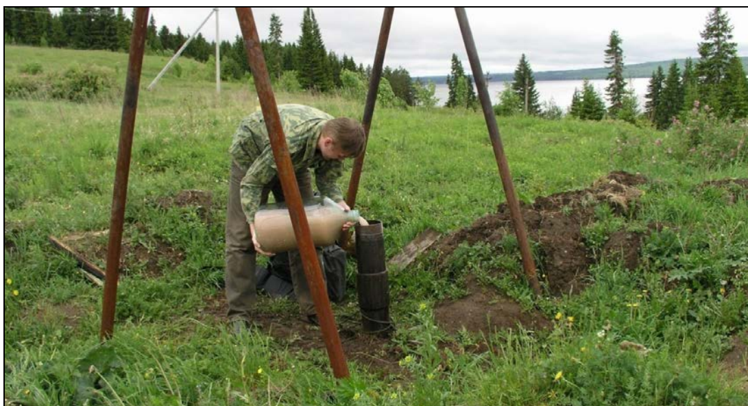
Рис. 4. Заливка культуры нефтеокисляющих бактерий в скважину
