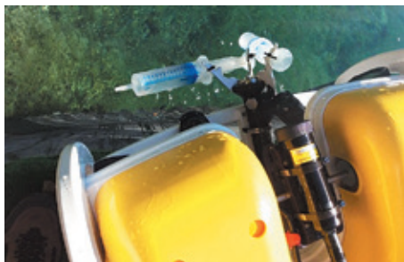
Рис. 3. Шприц для отбора воды, прикрепленный к ТНПА «Марлин-350»
