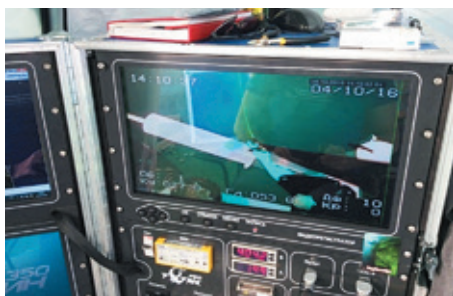
Рис. 4. Подъем шприца с пробой воды с глубины 200 м
