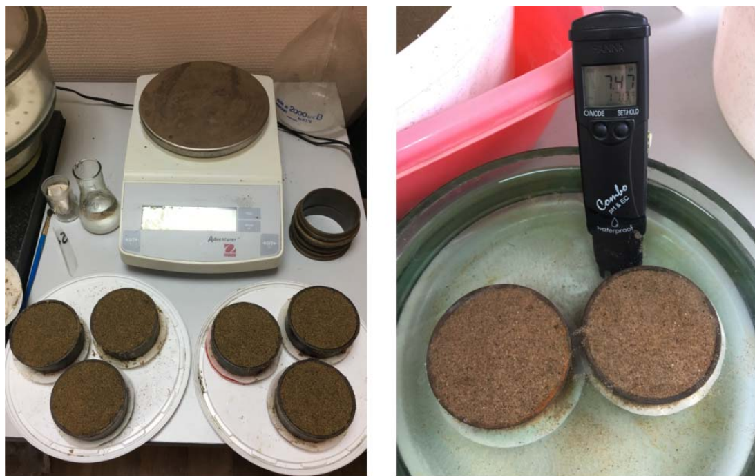
Рисунок 2 – Обработка грунтов веществом-ингибитором ( \text{FeCl}_3 )
