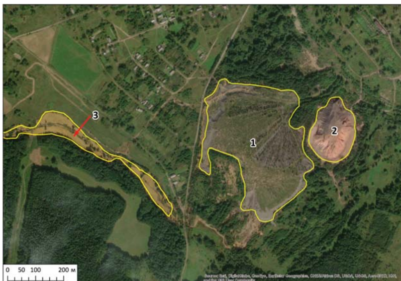
Рис. 3. Плоский (1), конусный (2) породные отвалы и пойма р. Вящер (3) на снимке сверхвысокого пространственного разрешения с сервиса ArcGIS Imagery
