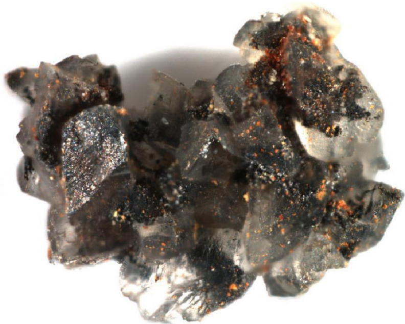
Рисунок 2-1 Агрегат прозрачных зерен кальцита в отложениях дренажной системы земляной плотины (по: [75])
